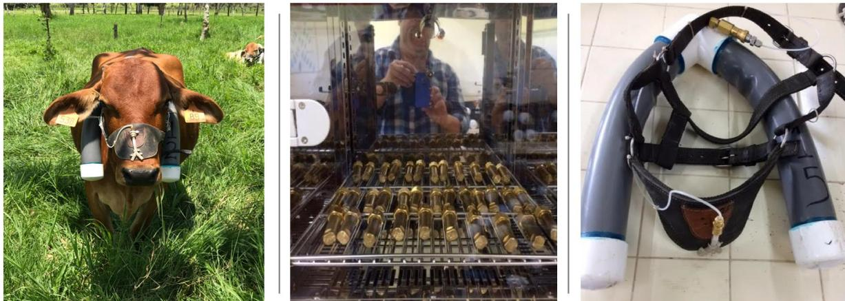
**Figura 2.** Materiales y equipos empleados para el experimento de metano entérico con ganado vacuno en Costa Rica
